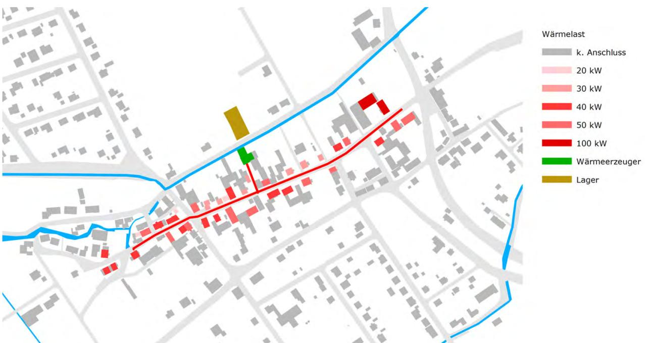
Abb. 21: Beispiel für ein Nahwärmenetz
